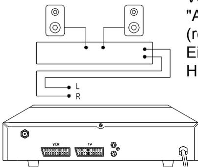
Verbinden Sie die Ausgangsbuchsen "Audio L" (linker Kanal) und "Audio R" (rechter Kanal) (9) mit z.B. den AUX-Eingängen (L.+R.-Kanalbuchse) Ihrer HiFi-Anlage.
