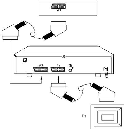
Schließen Sie hierzu ein Scartkabel an den VCR-Anschluß (7) des Satellitenreceivers und Ihres Videorecorders an . Beachten Sie hierbei die Bedienungsanleitung Ihres Videorecorders.
